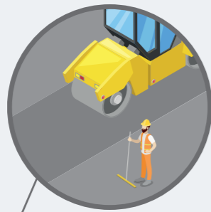
Réalisation de la couche de roulement (épaisseur 2,5 cm ou 4 cm)
