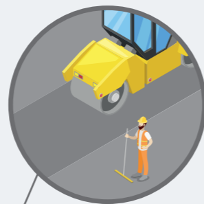
Réalisation de la couche de roulement 3 (épaisseur 2,5 cm ou 4 cm)
